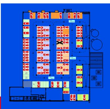
O Sistema Tembé utiliza as informações dos equipamentos de controle do estacionamento, lacos de detecão de veículos e, principalmente, dos detectores de veículos Guamá ou Piriá, para gerenciar as vagas do estacionamento.
